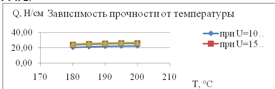
Рисунок 1 – График зависимости прочности клеевого соединения от температуры клея-расплава
