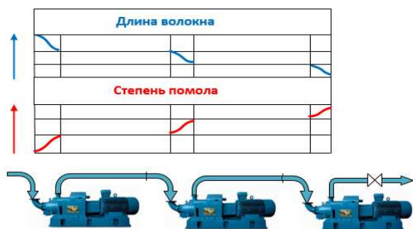
Рисунок 1 - Характерные изменения параметров качества волокнистой суспензии
