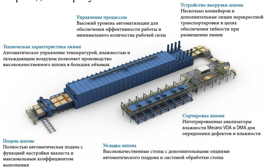
Рисунок – Линия сушки шпона «Grenzebach» и линия сортировки шпона «Raute»
