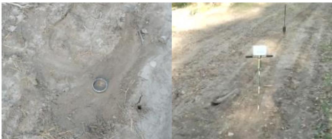
Рисунок 1 – Взятие пробы режущим кольцом и определение прочностных характеристик пенетрометром ПГ-3М
