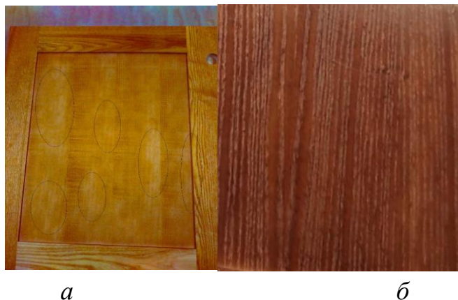
а – до нагрева поверхности древесины (с дефектом «яблочность»); б – после нагрева поверхности древесины до 30°С
